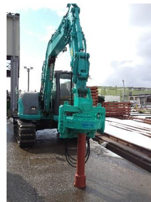
コベルコ建機 SK75 オーガ AG1500 鋼管チャック
