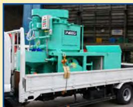
荷台の幅が 1.8m 以上、長さが 3.2m 以上あれば積載できます。本体質量も軽量に作りましたので、ユニック付きの車両でも積載できます。
