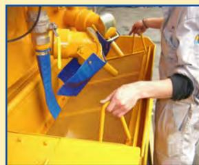
ミキサーで攪拌した液体は、ホッパーに流します。ホッパーには金網が取付けてあり、不純物を取除くことができます。また、ホッパー手前を斜めに切り欠いてあるので、金網を少し持ち上げるだけで容易に金網を取り出すことができます。
